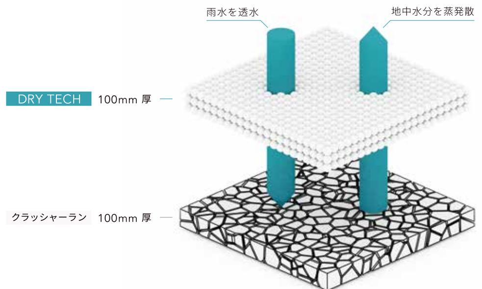
透水係数は $1 \times 10^{-1} \text{ cm/sec}$ 以上でゲリラ豪雨でも水たまりができない高い透水性能があります。多量の水が流入してもその空隙に貯水して少しずつ地中に浸透、蒸発散させ、流出を抑制します。蒸発散する際、表面温度が下がる“打ち水効果”もあり、ヒートアイランド現象抑制に寄与できます。アスファルト舗装のように熱や紫外線で劣化して空隙がつぶれる心配はなく、曲げ強度も2.8Nと高く、コンクリートと同様に長持ちします。
